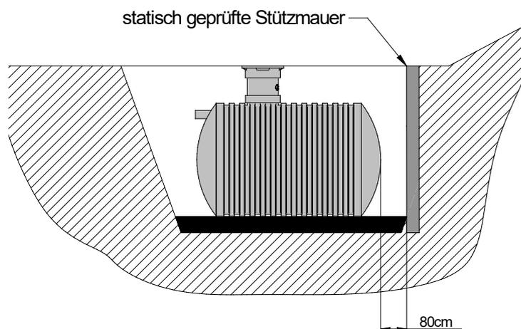
Bei Verlegung des Wassertanks parallel bzw. quer zum Hang muss ein Mindestabstand von Behälterdurchmesser plus 70cm zur Böschung eingehalten werden.
