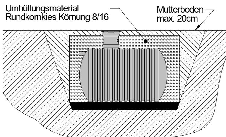
**VOR DEM UMHÜLLEN DES WASSERSPEICHERS SOLLTEN ALLE TANKVERSCHRAUBUNGEN, ANSCHLÜSSE, STECKVERBINDUNGEN,... AUF DICHTHEIT ÜBERPRÜFT WERDEN!**
