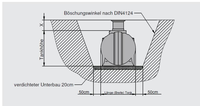
Der Teleskopdomschacht lässt sich in der Höhe reduzieren und dadurch an das Gelände anpassen. Die Abdeckung ist verschraubt und somit kindersicher ausgeführt.
