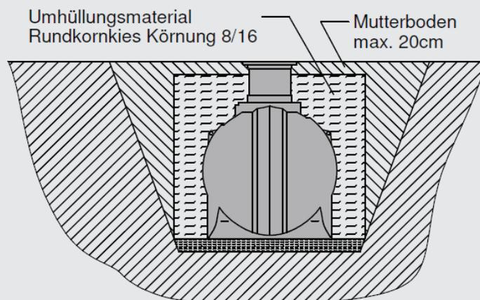
**VOR DEM UMHÜLLEN DES WASSERSPEICHERS SOLLTEN ALLE TANKVERSCHRAUBUNGEN, ANSCHLÜSSE, STECKVERBINDUNGEN,... AUF DICHTHEIT ÜBERPRÜFT WERDEN!**
