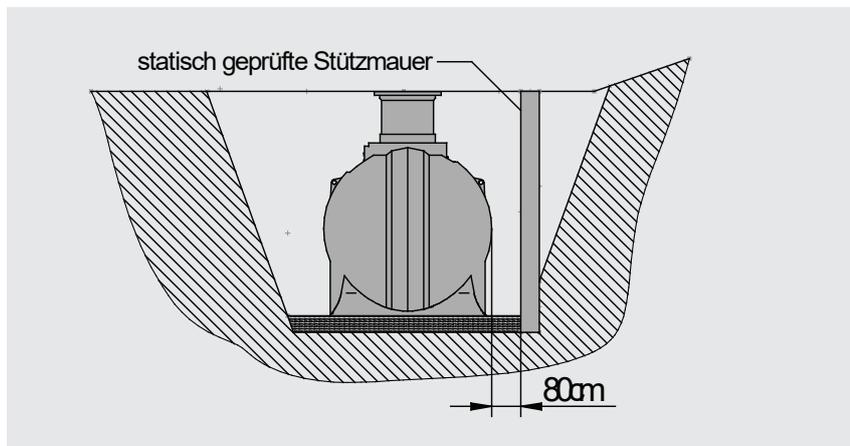
Bei Verlegung des Wassertanks parallel bzw. quer zum Hang muss ein Mindestabstand von Behälterdurchmesser plus 70cm zur Böschung eingehalten werden.
